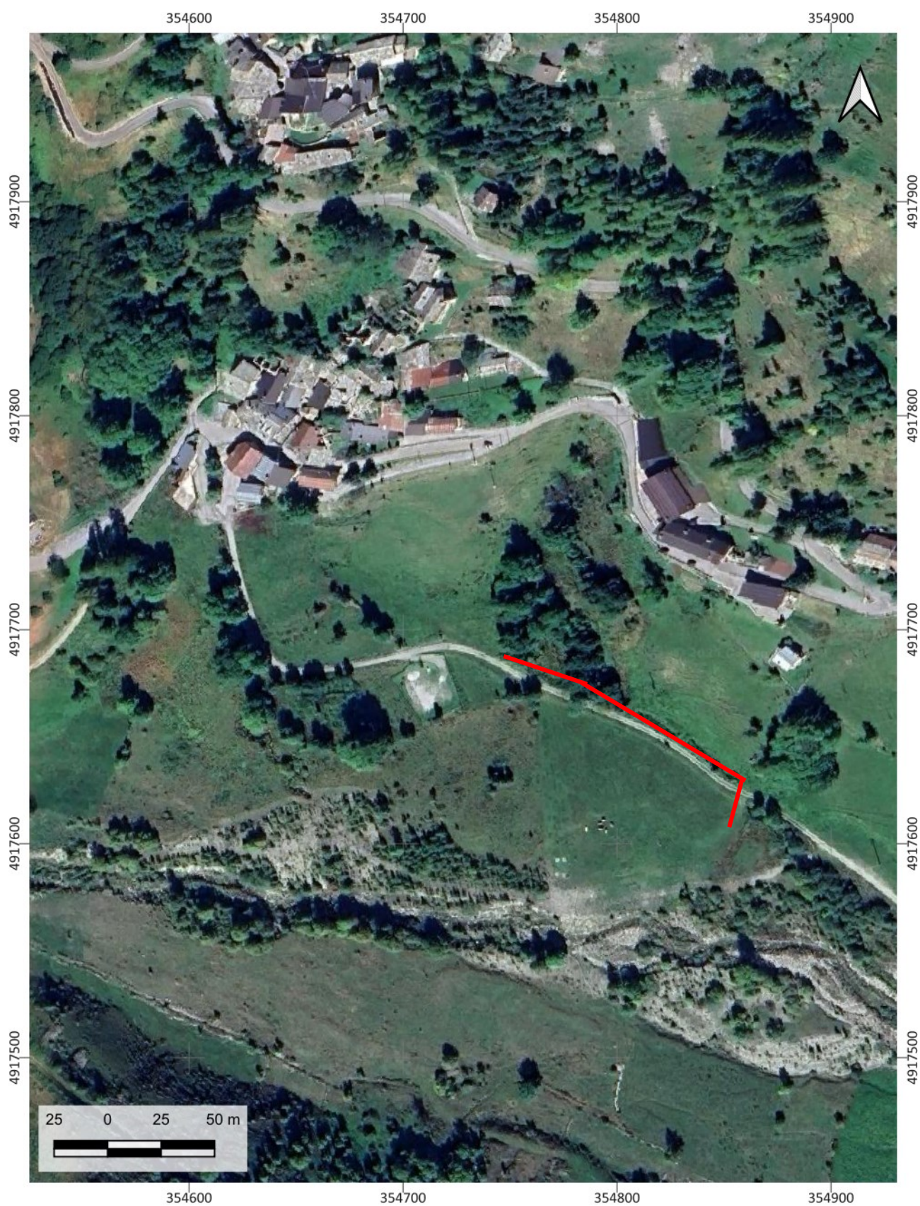
Figura 4 – Ubicazione da immagine satellitare delle condotte in progetto sovrapposta a immagine satellitare Bing Satellite. Scala 1:5.000.
